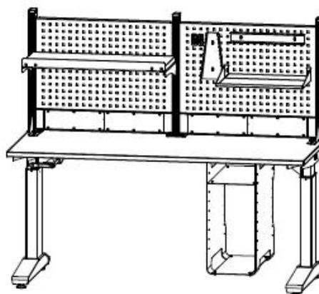
Пример монтажного стола CP-150-01 с экраном и подвесным модулем
