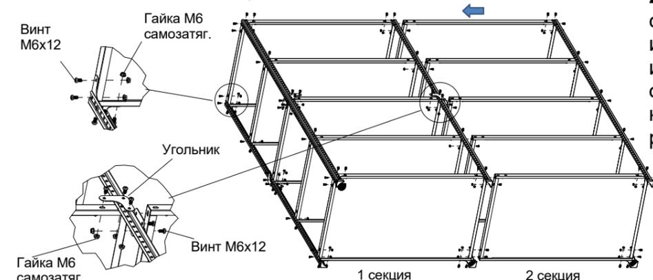
**2.4.** Установить ограничители к стойкам при помощи винтов М6х12 и гаек М6. Боковые ограничители имеют 2 места крепления, ограничители по ширине - 3 места крепления. Установить разделители книг.
