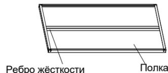
**2.3.** Последовательно соединить Полки со Стойками. Стойки основного комплекта устанавливаются по краям многосекционного стеллажа, а Стойки промежуточного комплекта - во внутренней части многосекционного стеллажа, при этом зацепы на стойках должны плотно войти в соответствующие отверстия полок.
