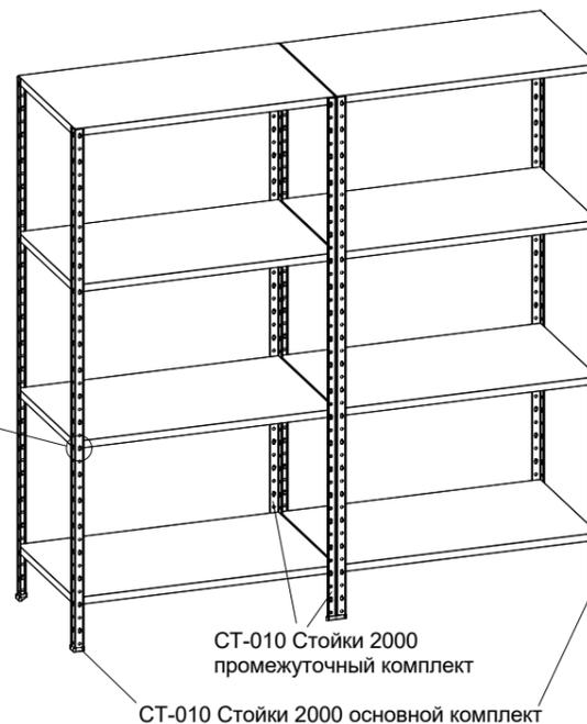
**!** Нижние полки установить во вторые зацепы снизу, остальные равномерно по высоте стеллажа!
