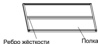
**2.3.** Последовательно соединить Полки со Стойками. Стойки основного комплекта устанавливаются по краям многосекционного стеллажа, а Стойки промежуточного комплекта - во внутренней части многосекционного стеллажа, при этом зацепы на стойках должны плотно войти в соответствующие отверстия полок.
