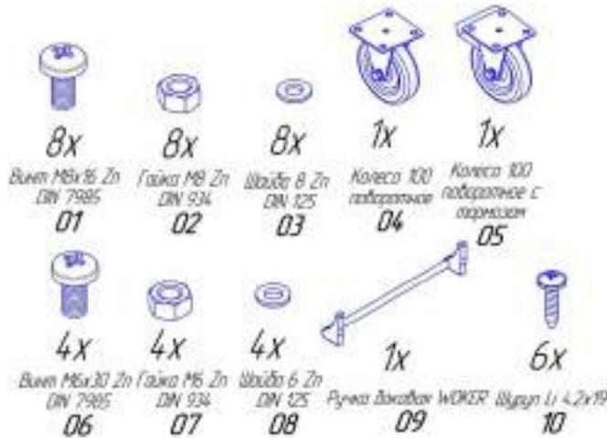
Комплект Опоры мобильной WOKER (артикул: 200-0002-00) состоит из Опоры WOKER (артикул: 200-0001-01) (см. стр.3), двух Колес, Ручки боковой WOKER и комплекта крепежа монтажного. Шурупы Li 4.2x19 (6 шт) необходимы для закрепления на Опоре мобильной WOKER Столешницы W 1000 WOKER (артикул: 200-0008-02) или Столешницы W 1200 WOKER (артикул: 200-0009-02), или Столешницы W 1500 WOKER (артикул: 200-0010-02), или Столешницы W 2000 WOKER (артикул: 200-0011-02).
