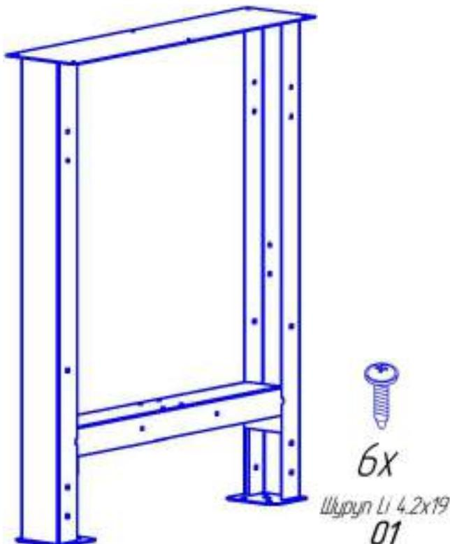
Опора WOKER (артикул: 200-0001-01) поставляется в собранном виде. Комплект крепежа монтажный необходим для закрепления на Опоре WOKER Столешницы W 1000 WOKER (артикул: 200-0008-02) или Столешницы W 1200 WOKER (артикул: 200-0009-02), или Столешницы W 1500 WOKER (артикул: 200-0010-02), или Столешницы W 2000 WOKER (артикул: 200-0011-02).
