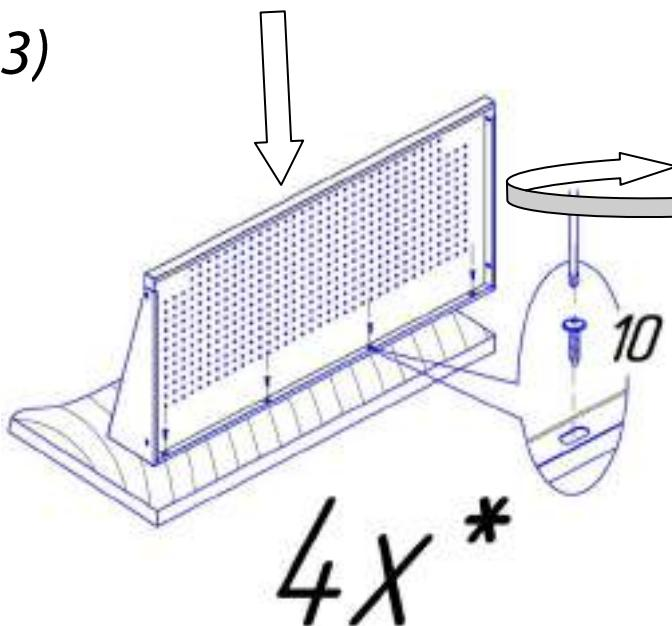
\* Количество шурупов Li 4.2x19 для закрепления задней стороны Экрана 1000 WOKER, Экрана 1200 WOKER - 4 шт, для Экрана 1500 WOKER – 5 шт, для Экрана 2000 WOKER – 7 шт.
