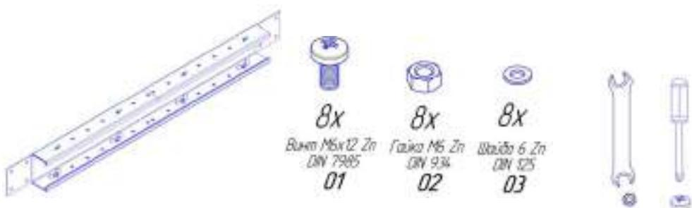
Траверса поставляется в собранном виде. Комплект крепежа монтажный необходим для соединения Траверсы с Опорами WOKER (в горизонтальной или вертикальной плоскости). Для Верстаков длиной 1000 мм разбирать Траверсу WOKER не нужно. Для других Верстаков необходимо, открутив гайки-барашки М6, извлечь декоративные болты М6, и, перемещая вправо и влево швеллеры Траверсы, совместить отверстия на них и на неподвижной части, добившись необходимой длины траверсы (L), собрать ее обратно.
