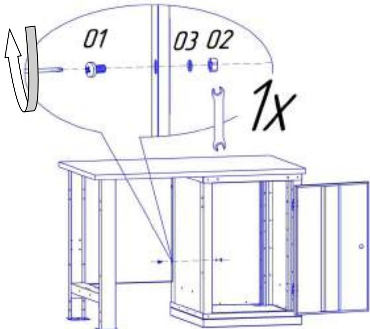
**2.2)** Если Тумба WOKER имеет ящики, то их надо извлечь. Для этого их необходимо выдвинуть и нажать на фиксаторы, как показано на рис. (см. ниже). Затем закрепляется стенка, как показано на рис. выше. Установка полки тоже производится без ящиков или при открытой дверце.
