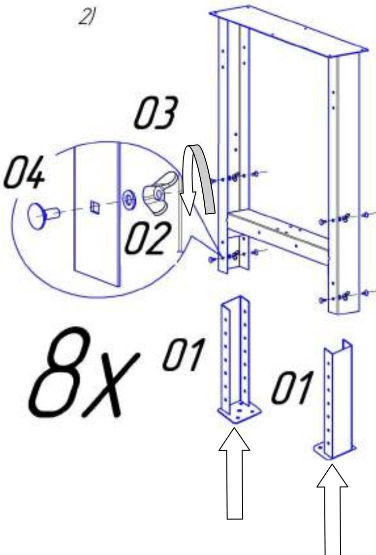
Шаг регулирования Опоры регулируемой WOKER 50 мм. При подъеме, начиная с третьего отверстия от площадки, Вставку необходимо крепить не на первое и третье отверстие в Опоре WOKER (см. рис. выше), а на первое и второе. **Запрещается** крепить Вставку на одно отверстие в Опоре WOKER.
