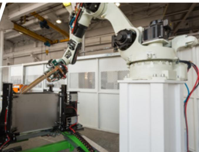
В цеху работают два сварочных комплекса. Эти роботы обеспечивают высокую скорость и точность сварки.
