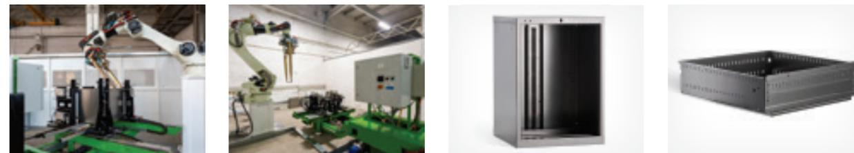
Корпуса тумб и ящики полностью сварные. Применение роботизированных сварочных комплексов гарантирует неизменно высокий уровень качества.
