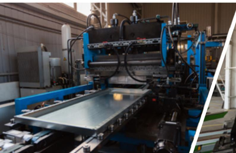
Стеллажи изготавливаются на станках полного цикла. Длина станка — 56 метров. Производительность — 12 полок в минуту.
