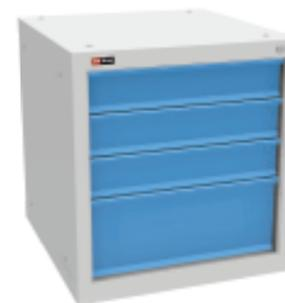
Инструментальная тумба с 4 ящиками: h100, h100, h100, h200. Сварной корпус и ящики. Может использоваться как подвесной модуль верстака ВЛ-К. Максимальная нагрузка на ящик — **30 кг**. Ключевой замок EURO-LOCKS (Германия). Корпус — **RAL 7038**, ящики — синий **RAL 5012**.
