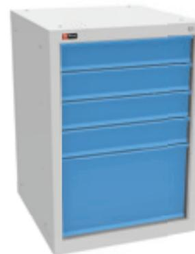
Инструментальная тумба с 5 ящиками: h100, h100, h100, h300. Сварной корпус и ящики. Может использоваться как модуль верстака ВЛ-К. Максимальная нагрузка на ящик — **30 кг**. Ключевой замок EURO-LOCKS (Германия). Корпус — **RAL 7038**, ящики — синий **RAL 5012**.
