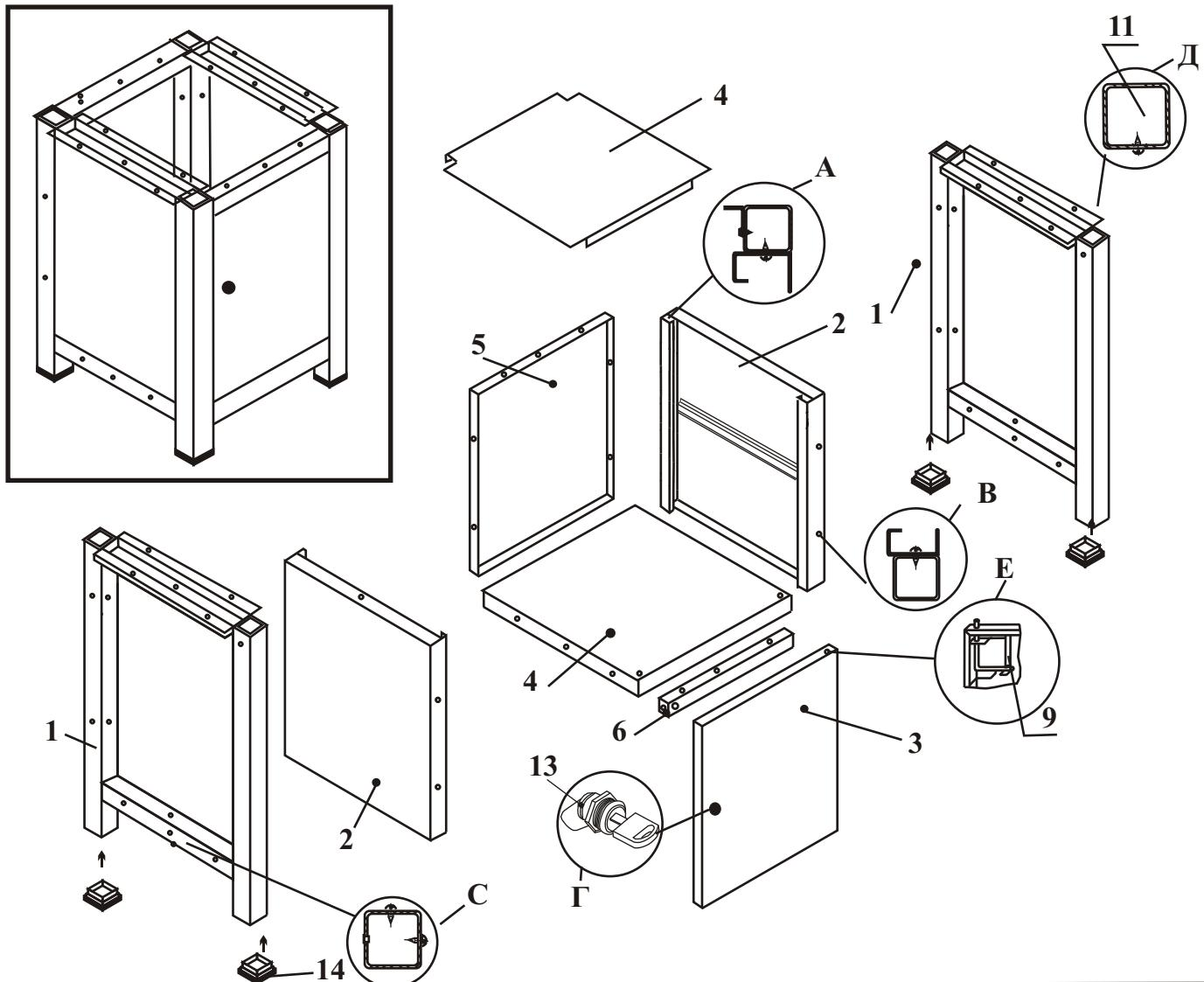
На опору поз.1 закрепить заглушки пластмассовые поз.14
